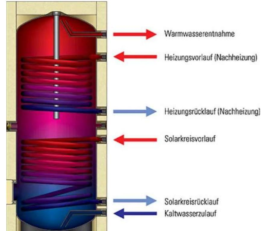
Kernstück einer Solarthermieanlage ist der Sonnenkollektor verbunden mit dem Solarspeicher.
