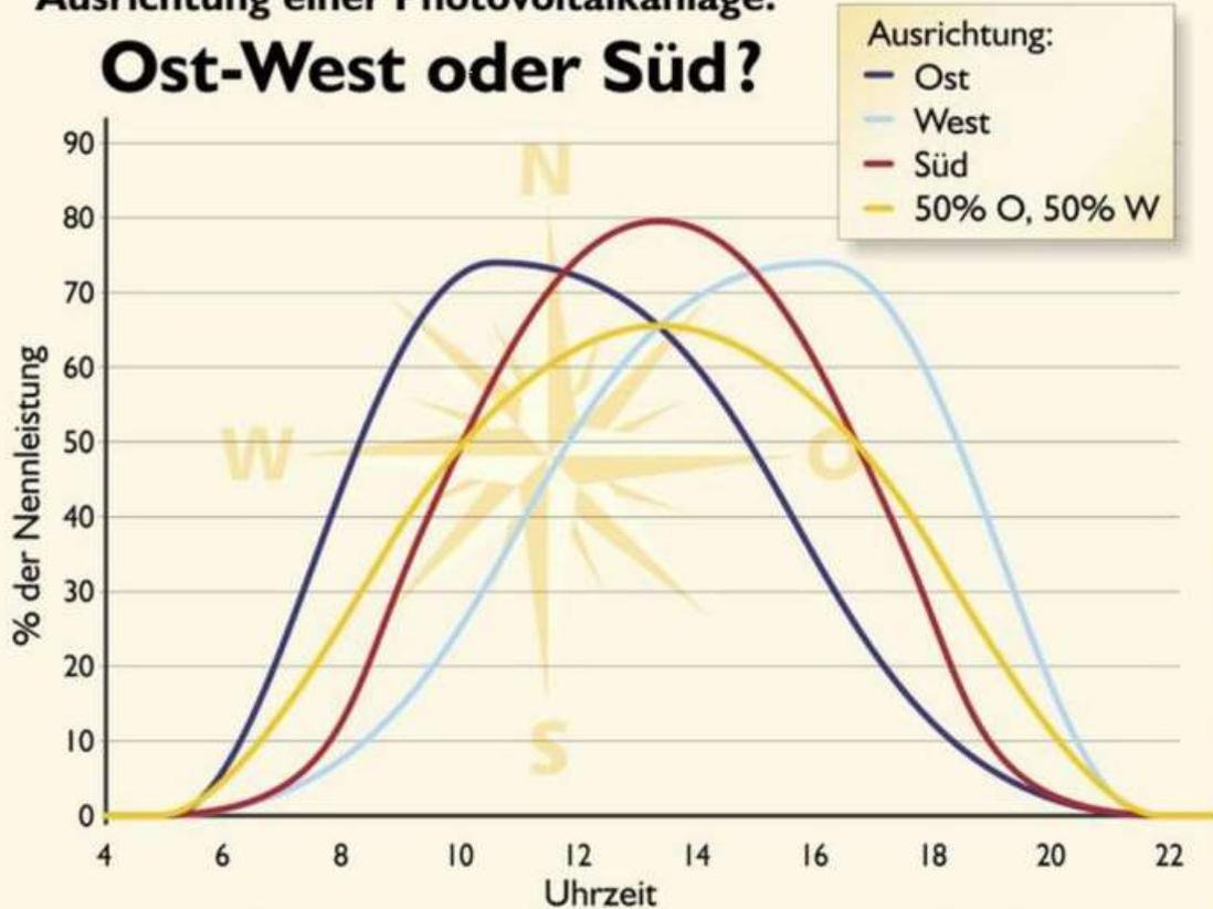
Vergleich von Photovoltaikanlagen unterschiedlicher Ausrichtung an einem Sonnentag (8. Juli 2013)
