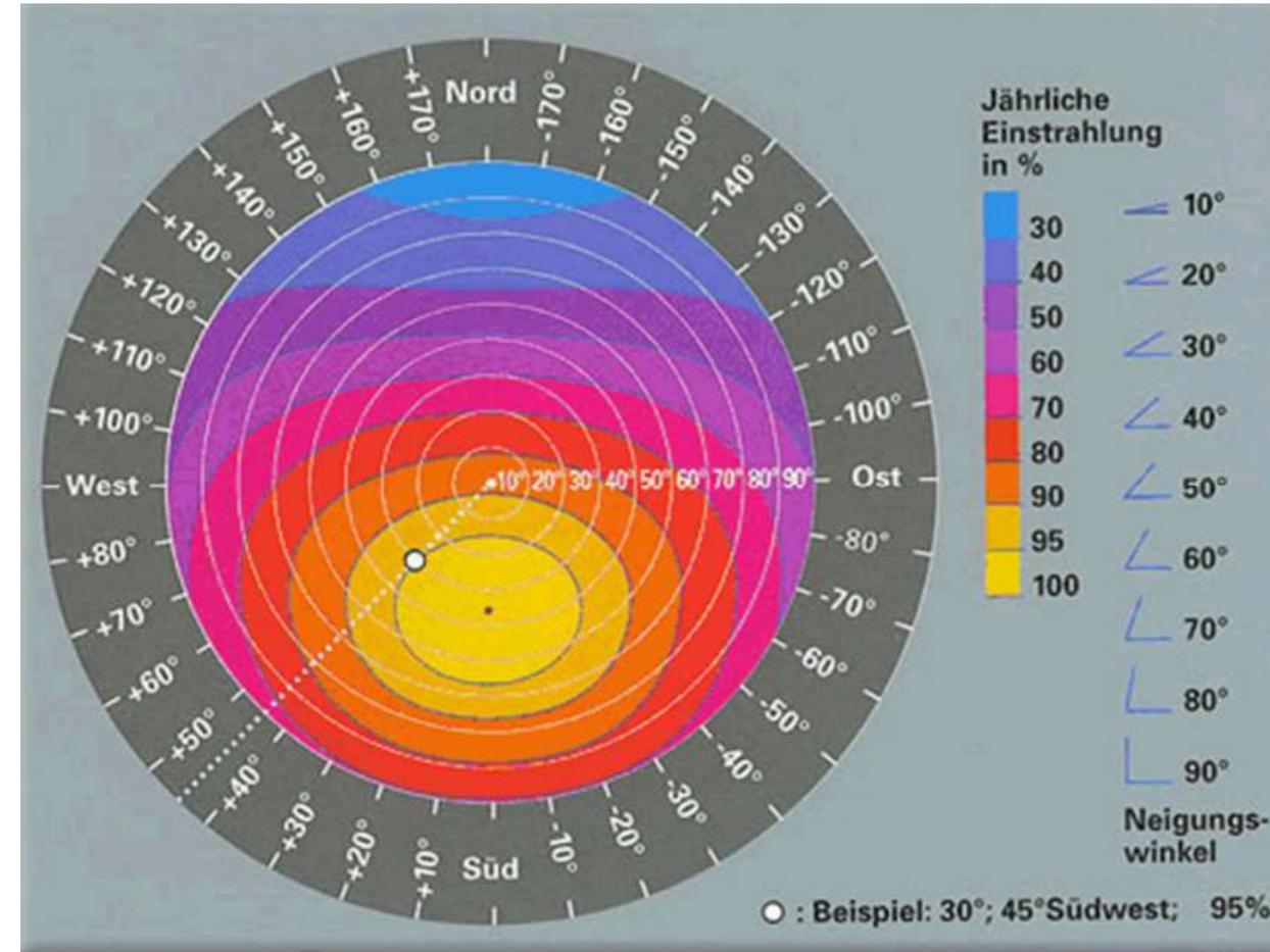
Je weiter das Solarmodul von Süden entfernt ist, desto flacher sollte es montiert werden!
